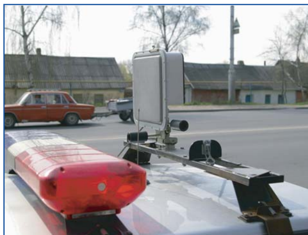
Оборудование беспроводной связи, установленное на патрульном автомобиле
